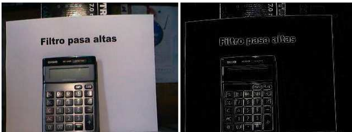
Fig.1.5. Izquierda: entrada del filtro, derecha: salida del filtro, podemos ver como enfatiza los bordes.
