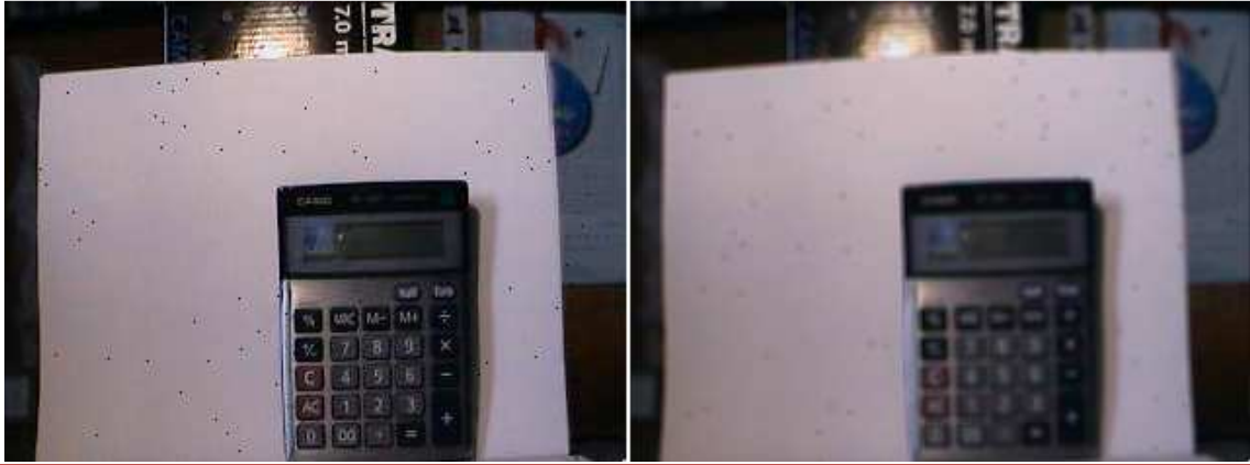
Fig. 1.4. Entrada del filtro pasa bajas (izquierda), salida del filtro pasa bajas (derecha)
