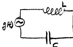
$$\begin{aligned} q(t) &= \text{càrrega del condensador.} \\ I(t) &= \dot{q}(t) \quad \text{intensitat de corrent.} \end{aligned} \quad L\dot{I} + \frac{q}{C} = g(t)$$
